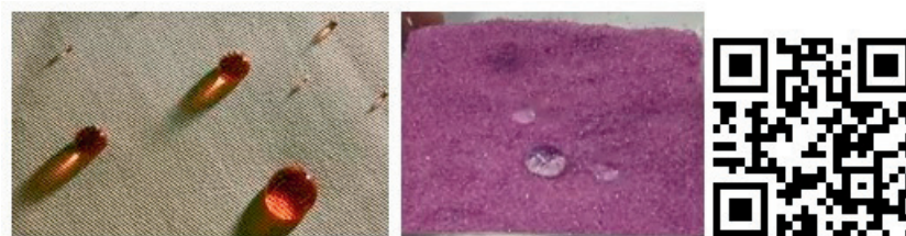
Obr. 50 Superhydrofóbný povrch nanotextílie (vľavo) a magického piesku (vpravo)
