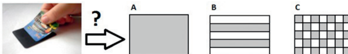
Obr. 21 Určenie štruktúry vzorky pomocou magnetickej sondy
